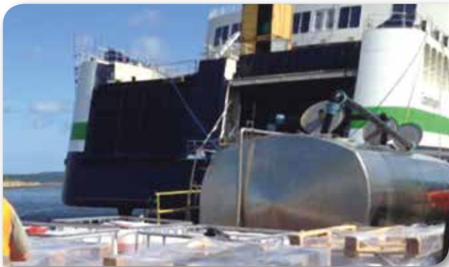
Rentvandstanke på vandværker og skibe bør inspiceres hvert år
